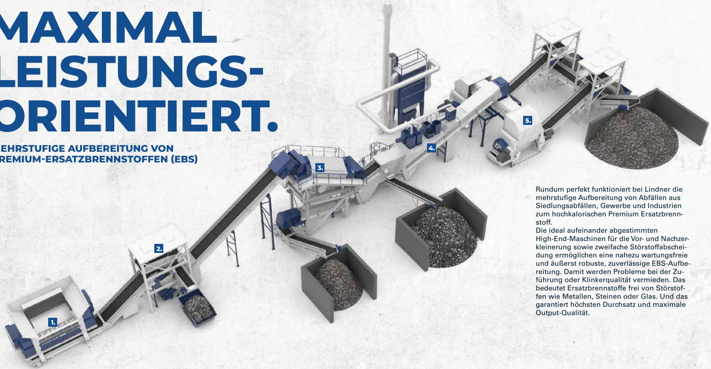
Rundum perfekt funktioniert bei Lindner die mehrstufige Aufbereitung von Abfällen aus Siedlungsabfällen, Gewerbe und Industrien zum hochkalorischen Premium Ersatzbrennstoff.
